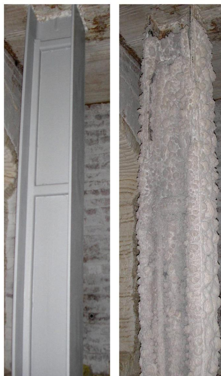
Фото 1. Вид колонны с огнезащитным вспучивающимся покрытием до и после проведения испытаний
