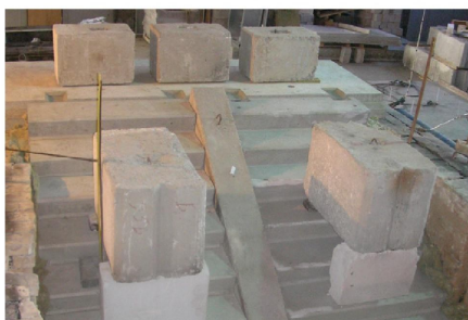
Фото 9. Испытание маршей с лестничной площадкой
