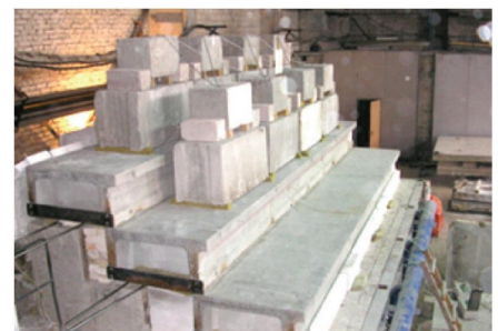
Фото 8 Испытание складок трибун НСК «Олимпийский»
