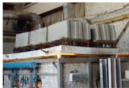
Фото 7. Испытание монолитной плиты перекрытия
