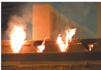
Фото 6. Горение пароизоляции в гофрах профнастила во время испытаний на огнестойкость кровли (к рис. 6)
