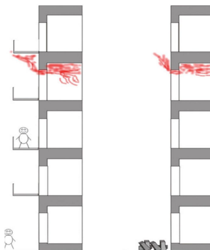
Рис. 3 Сценарий обрушения балконов
