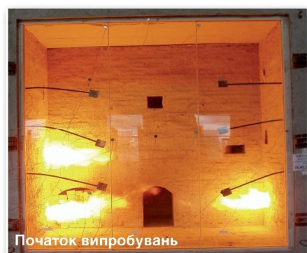
Фото 3. Випробування на вогнестійкість заскленої протипожежної перегородки без каркасу (ущільнення між скляними панелями силіконом)
