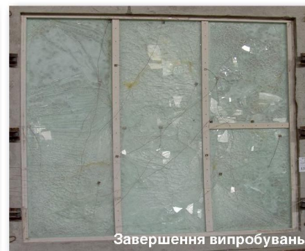
Фото 2. Випробування на вогнестійкість заскленої протипожежної перегородки з каркасом із неметалевих матеріалів
