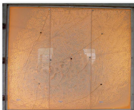
Фото 3. Випробування на вогнестійкість заскленої протипожежної перегородки без каркасу (ущільнення між скляними панелями силіконом)
