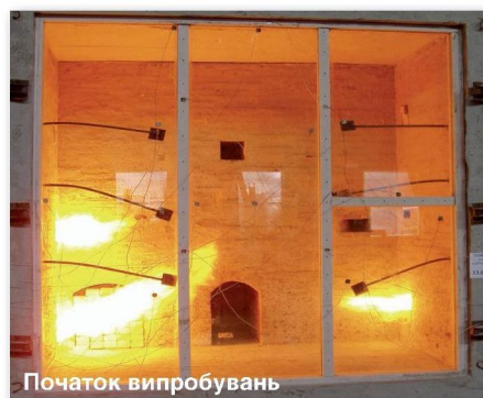
Фото 2. Випробування на вогнестійкість заскленої протипожежної перегородки з каркасом із неметалевих матеріалів
