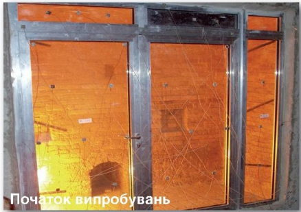
Фото 5. Випробування на вогнестійкість заскленої протипожежної перегородки з дверима
