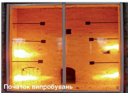
Фото 6. Випробування на вогнестійкість суцільного стрічкового засклення будівель
