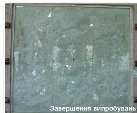
Фото 3. Випробування на вогнестійкість заскленої протипожежної перегородки без каркасу (ущільнення між скляними панелями силіконом)
