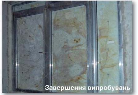
Фото 5. Випробування на вогнестійкість заскленої протипожежної перегородки з дверима
