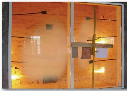
Фото 6. Випробування на вогнестійкість суцільного стрічкового засклення будівель
