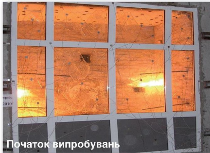
Фото 4. Випробування на вогнестійкість заскленої протипожежної перегородки з алюмінієвим каркасом
