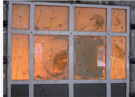
Фото 4. Випробування на вогнестійкість заскленої протипожежної перегородки з алюмінієвим каркасом
