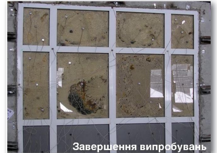
Фото 4. Випробування на вогнестійкість заскленої протипожежної перегородки з алюмінієвим каркасом
