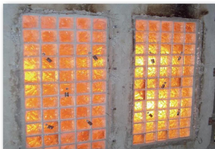
Фото 1. Випробування на вогнестійкість застакленої перегородки з прозорих будівельних блоків
