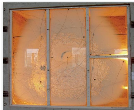
Фото 2. Випробування на вогнестійкість заскленої протипожежної перегородки з каркасом із неметалевих матеріалів
