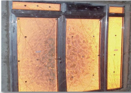
Фото 5. Випробування на вогнестійкість заскленої протипожежної перегородки з дверима
