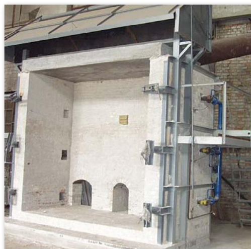
Рис. 1. Вигляд вертикальної печі для випробувань дверей
