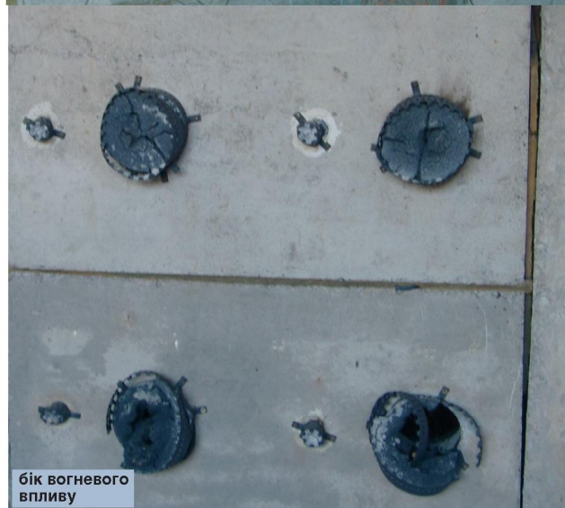
Рис. 2. Вигляд проходів пластмасових труб крізь фрагмент стіни
