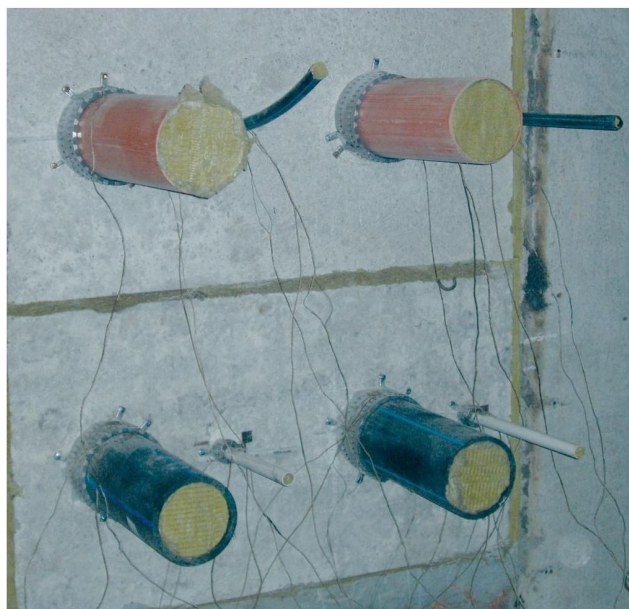
Рис. 1. Вигляд проходів пластмасових труб крізь фрагмент перекриття
