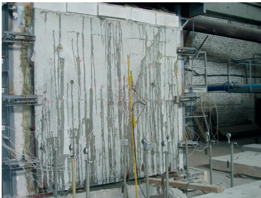
Випробування фрагмента залізобетонної несучої стіни
