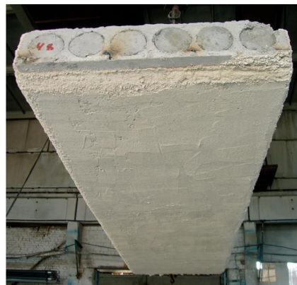
Фрагмент залізобетонної стіни. Руйнування захисних шарів бетону до несучої арматури під впливом стандартного температурного режиму
