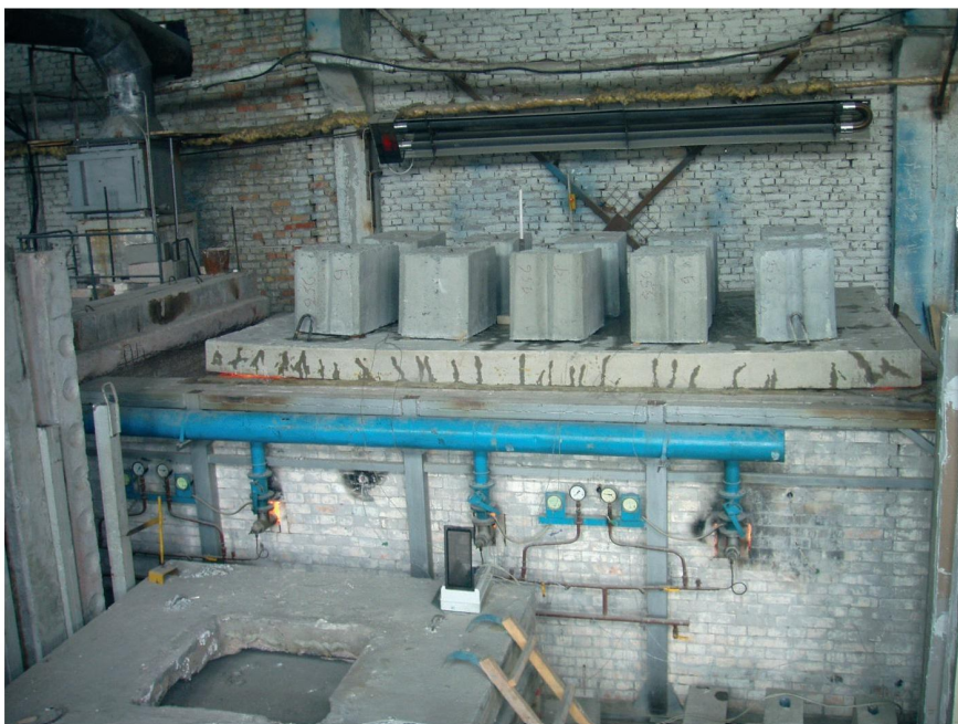
Випробування фрагмента залізобетонного монолітного перекриття
