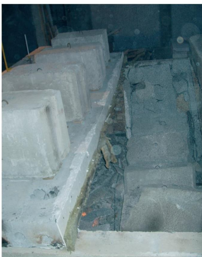
Руйнування (обрушення) залізобетонних плит перекриття з попередньо напруженою несучою арматурою під час випробувань
