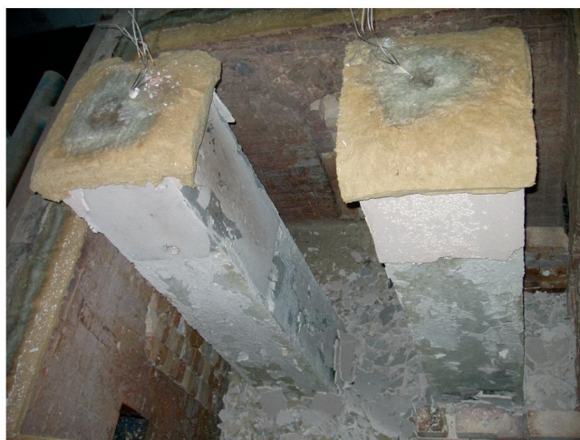
Вигляд пустотної плити перекриття з нанесеною вогнезахисною штукатуркою до й після випробування (180 хв.)
