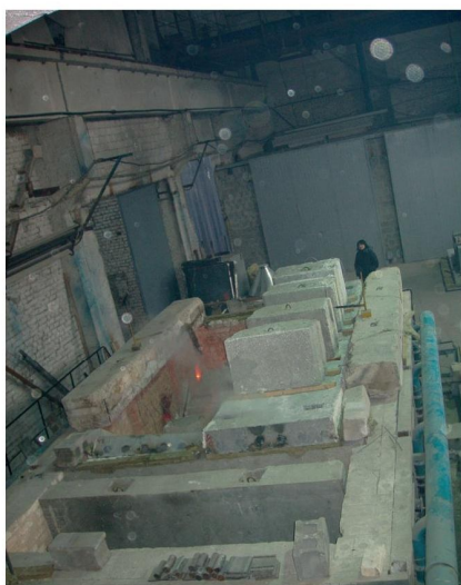
Руйнування (обрушення) залізобетонних плит перекриття з попередньо напруженою несучою арматурою під час випробувань
