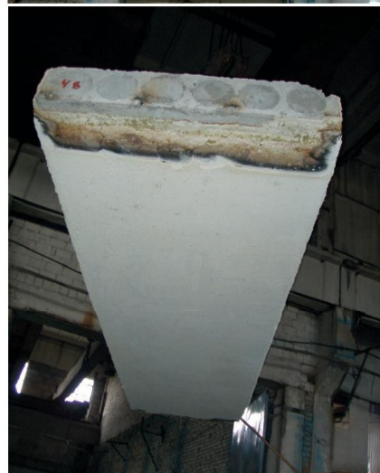
Вигляд пустотної плити перекриття з нанесеною вогнезахисною штукатуркою до й після випробування (180 хв.)
