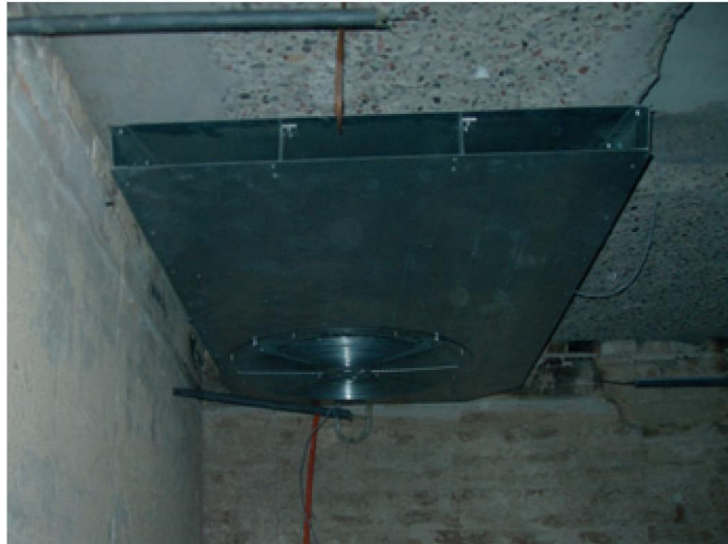
Розташування вентилятора переміщення диму у вогневій печі*
