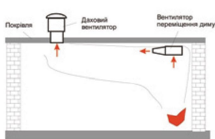
Принцип дії дахових вентиляторів димовидалення та вентиляторів переміщення диму
