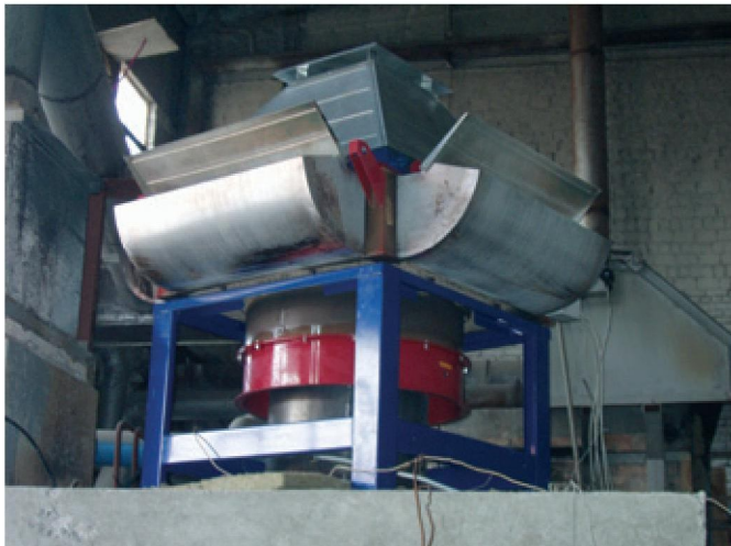
Випробування дахового вентилятора димовидалення*
