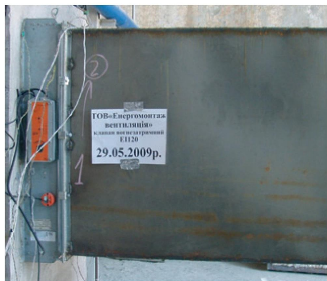
Випробування вогнезахисного клапана*
