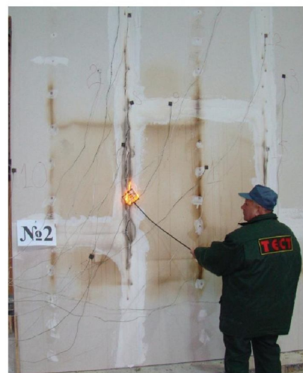
Рис. 6. Потеря целостности перегородки на 115 минуте испытаний
