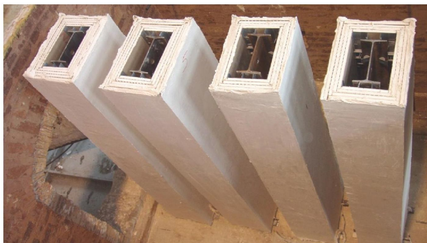
Рис. 2. Вид стальных колонн в печи, которые облицованы гипсокартонными плитами
