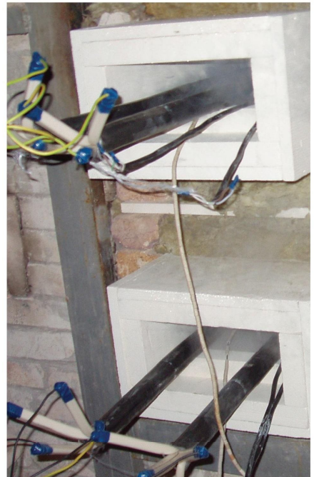
Випробування на вогнестійкість алюмінієвих кабелів, що прокладені в коробах
