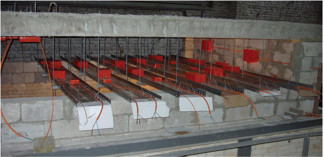
Підготовка до випробувань вогнестійких кабельних ліній з розподільчими коробками
