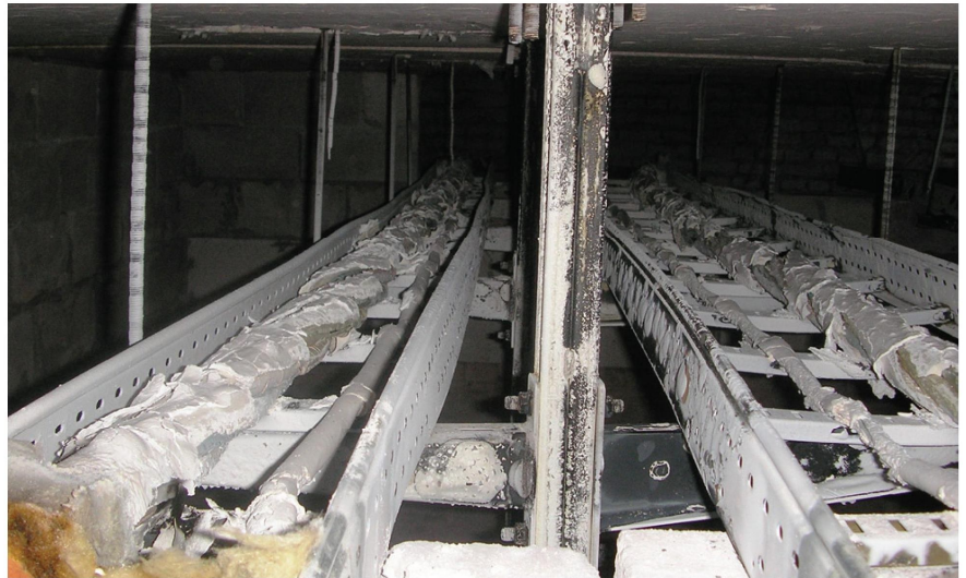
Випробування на вогнестійкість алюмінієвих кабелів, що прокладені в коробах
