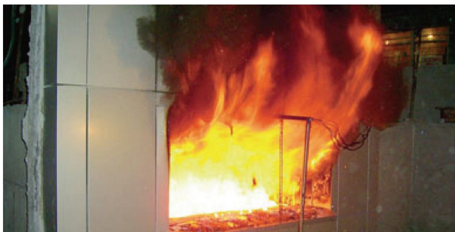
Фото 1. Внешний вид испытательной установки по ГОСТ 31251 и образца системы утепления зданий с вентилируемым воздушным зазором.
