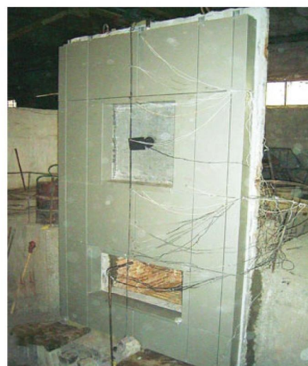
Фото 2. Внешний вид образца системы утепления зданий с облицовкой АКП во время испытаний по ГОСТ 31251.
