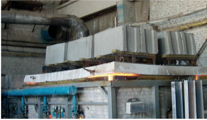
Випробування плити перекриття під навантаженням
