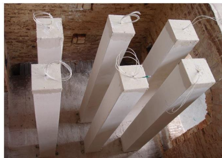
Випробування сталевих колон із вогнезахисним облицюванням
